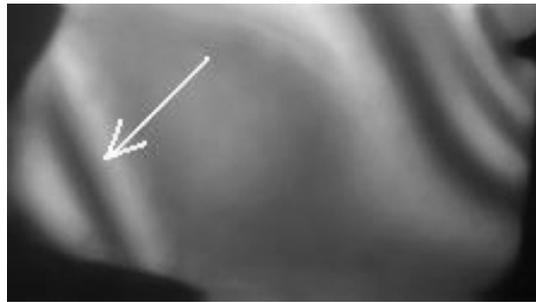
Figura 3 – Imagem de um modelo fotoelástico com indicação de ponto onde  $N = 1,24$
